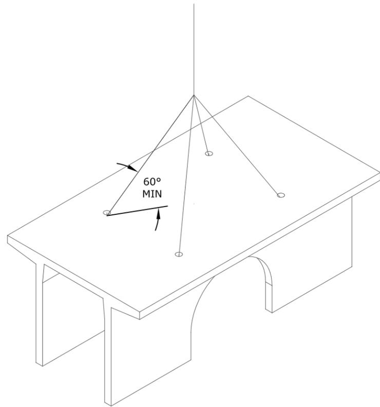
**MODULE LIFTING DETAIL**
